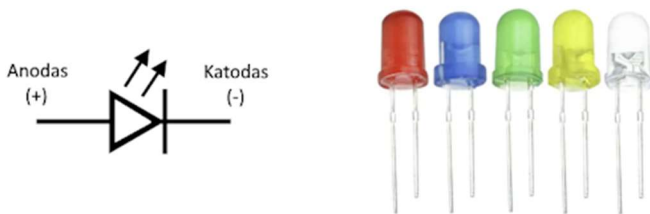
6.3.1 pav. Šviesos diodo simbolis ir vaizdai
