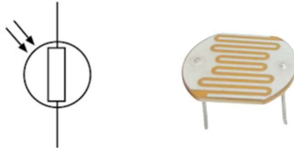
4.2.1 pav. Fotorezistoriaus simbolis ir realus vaizdas
