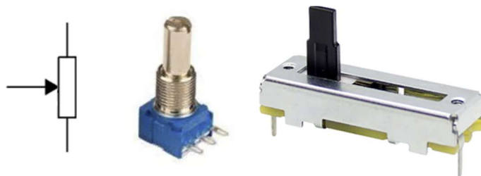
4.1.3 pav. Potenciometro simbolis ir realus vaizdas
