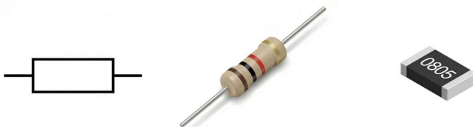
4.1.1 pav. Rezistoriaus simbolis ir realus vaizdas
